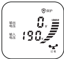
过载保护：当机器超过额定功率时，机器停止输出。
